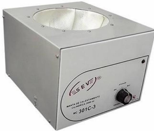
Manta para reactor cilíndrico fondo esférico. Ésta manta se fabrica con calefactor de fibra cerámica y resistencia de cromo- níquel, cuenta con control de temperatura de rango infinito que permite regular un temperatura estable, su forma permite calentar reactores cilíndricos con fondo esférico.
