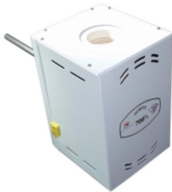
El gabinete exterior es fabricado en lámina de aluminio con recubrimiento epoxi-poliéster, cuenta con perforaciones que sirven como ventilación para evitar que se caliente. Se suministra con una barra soporte para fijar el rack y con patas de goma para colocarlo sobre la superficie. El horno se suministra con termopar tipo K integrado que mide el área de calentamiento con conector externo que facilita la adaptación de un control de temperatura, cable de alimentación polarizado.
