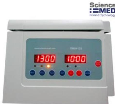
Equipo diseñado para separación de componentes, obtención de suero y plasma, análisis de orina y materia fecal. Diseño robusto, equipado con programas predeterminados y rotor de ángulo fijo. Ampliamente utilizado en laboratorios de diagnóstico, clínicas, hospitales, universidades, banco de sangre, institutos de investigación, etc.
