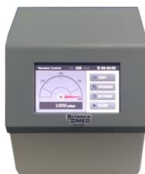
El controlador para bomba de vacío es un dispositivo para laboratorios, que sirve para mostrar, ajustar y controlar los sistemas de vacío. Generalmente, el sistema de vacío es constituido por la bomba de vacío y su controlador; junto con el evaporador rotativo, permite un proceso de destilación repetible y la recuperación de muchos tipos de solventes de manera eficiente y automática.
