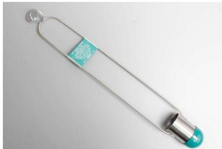
Copa de viscosidad Zahn con tolerancia garantizada del 3% cumple y excede ASTM D4212.
