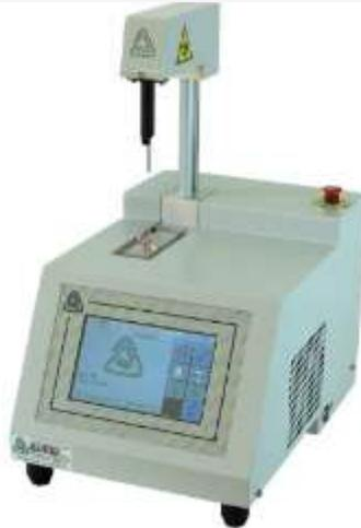
CryoTouch 1 es un equipo automático para la rápida y exacta determinación de la variación del punto de congelación de leche y nata, y del porcentaje de agua añadida en el pleno respeto de la norma internacional IDF-ISO 5764:2009.
