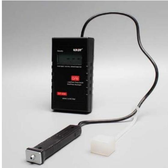
El modelo DT200 es un densitómetro robusto y fácil de usar. Su dimensión lo hace muy portátil y además cuenta con una sonda separada para la medición de la densidad de la película de rayos X.
