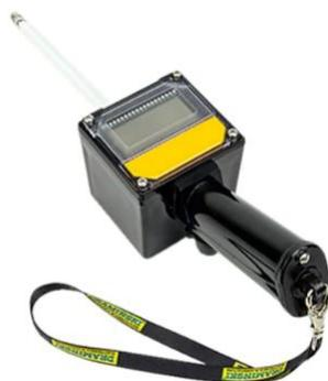
Detector de ovulación, utilizado para determinar la fecha optima de apareamiento. El dispositivo utiliza la relación entre cambios en la resistencia eléctrica del moco para reconocer los trastornos del ciclo estral y determinar el momento óptimo para la reproducción. La medición es fácil de hacer y completamente segura para pruebas en animales.
