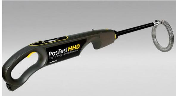
El detector holiday de alto voltaje (HHD) PosiTest es un detector holiday de CC de tipo pulso diseñado para localizar pequeños defectos y discontinuidades (llamados "orificios" o "holiday") en un sistema de recubrimiento protector aplicado a un sustrato conductor.
