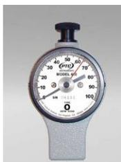
El durómetro **análogo de estilo ergonómico 410** mide la dureza del caucho suave, rodillos de impresión suave, bobinas textiles y otros materiales similares. El modelo 410 cumple o excede las especificaciones de la Sociedad Americana para pruebas y materiales (ASTM) D2240 escala "O".
