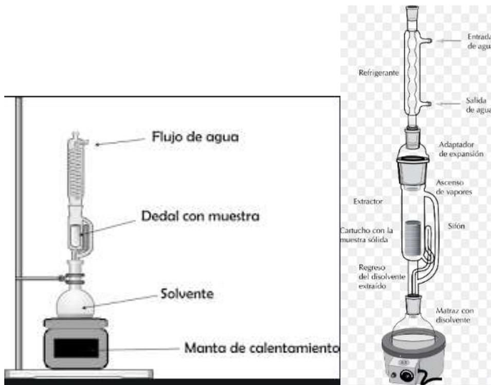
MC500 Mantilla de calentamiento con gabinete de acero inoxidable, aislamiento de fibra cerámica, con control de voltaje, para matraz de 500 ml. Alcanza una temperatura de hasta 450°C. Opera con 120 volts. Marca: Fab. Nal.
