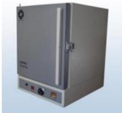
Horno de secado con doble control de temperatura (uno digital otro hidráulico de seguridad) desde ambiente hasta 250°C con sensibilidad de +- 1°C a 100°C interior de acero inoxidable de 45x45x45cms, convección mecánica (aire forzado), se incluyen 2 entrepaños, opera con 120 volts. **Fab. Nac.**
