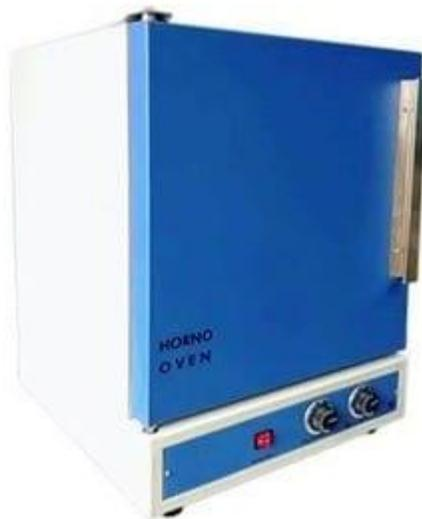
De convección natural (por gravedad), con doble control de temperatura (uno digital otro hidráulico de seguridad) desde ambiente hasta 220C° con sensibilidad de +1°C a 100C°,
