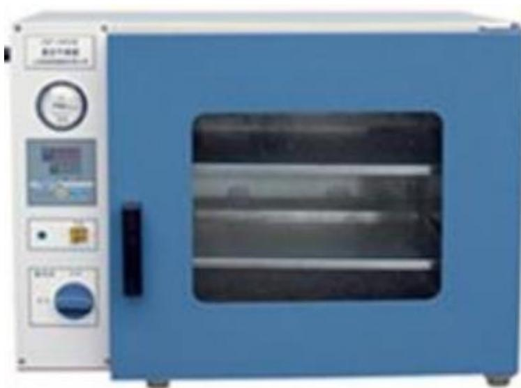
Con control electrónico de temperatura desde ambiente hasta 200º, sensibilidad de +1.5º C a 100º C, interior de acero inoxidable de 30 x 30 x 27 cm (Cap. 24.30 litros). Con ventana de cristal templado, válvula de vacío, válvula de alivio, vacuómetro de 0-30" y dos entrepaños; Dimensiones exteriores 59 x 49 x 45 cm. Opera con 120 volts.
