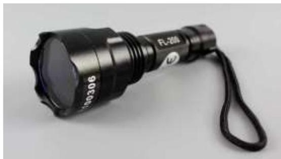
Esta linterna de Luz LED ultravioleta o luz negra modelop LC-FL200 tiene la intensidad necesaria y la longitud de onda apropiada para las inspecciones de líquidos penetrantes fluorescentes. La lámpara cuenta con luces LED UV que puede usar en dos modos de operación “enfoco” y “difusión”. La luz LED tiene la ventaja de no requerir tiempo de calentamiento y su vida útil es de hasta 30,000 horas (en condiciones normales).
