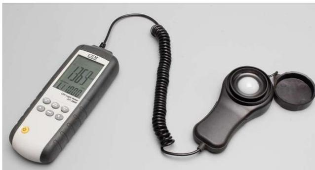
Es diseñado para la industria de LED, la industria del medio ambiente, con una amplia gama, alta precisión y alta sensibilidad y otras características, para asegurar el efectivo y correcto funcionamiento cada vez que se mide.
