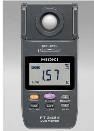
El FT3424 es un medidor de luz diseñado para una amplia gama de aplicaciones que involucran equipos de iluminación, trabajos de iluminación y administración de instalaciones. Capaz de probar incluso la iluminación LED, el FT3424 ofrece cinco rangos de medición, 20 lx a 200,000 lx, para admitir una amplia gama de niveles de luminancia.
