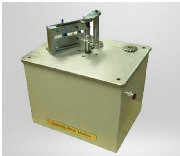
La muescadora de muestras ZKQ-20 se utiliza para hacer muescas en las muestras para la prueba de impacto IZOD y CHARPY. Los parámetros técnicos de esta máquina cumplen con los últimos estándares ISO 179, ISO180. La máquina de muescado de muestras ZKQ-20 puede preparar el tipo de muestra de prueba de impacto IZOD y CHARPY en el modelo de muesca es A, B y C. Se pueden hacer muescas en otros tipos de muestras diferentes mediante el cambio de la fresa y el perfilador de espesor de muestra estándar.
