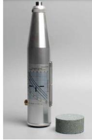
El martillo de prueba de concreto 225A se aplica para probar la resistencia a la compresión de la construcción de componentes de hormigón, puentes, etc.
