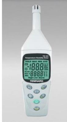
Medidor de temperatura / humedad TM-183
