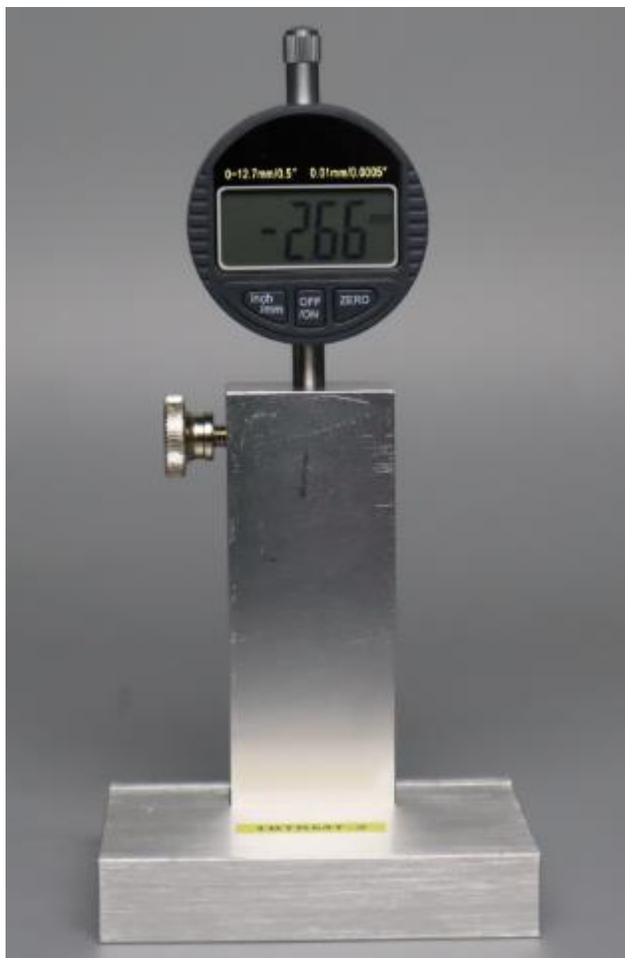
Este medidor de espesor de mano es un instrumento para medir el espesor de la señalización del pavimento, se puede utilizar tanto en laboratorio como en el sitio.
