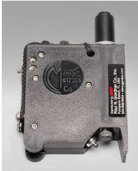
El Tooke Paint Inspection Gage IV es una herramienta de precisión para la inspección y medición de espesor de película seca (de acuerdo con ASTM D4138) de capas simples o múltiples sobre cualquier sustrato y para la observación microscópica y la medición de defectos de sustrato y película.
