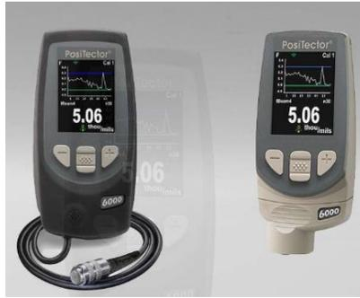
El Positector 6000 realiza mediciones precisas gracias a su sonda de precisión Dual con cable integrado, en superficies de metales ferrosos como el acero y en metales no ferrosos como el cobre, el aluminio, etc.
