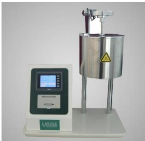
El flujo de índice de fluidez o Plastometro está diseñado de acuerdo con la norma ISO 1133. ASTM D1238 y D3364 de ASTM. Es adecuado para la determinación del MVR y MFR de termoplástico. Ha sido ampliamente utilizado en la prueba de los altos plásticos temperatura de fusión tales como PC, plásticos Fluor y nylon, PE, PP, POM, PS, plástico de resina ABS.
