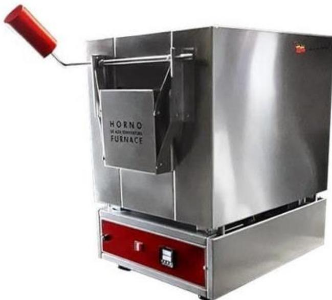
Control electrónico digital a base de microprocesador desde ambiente hasta 1200° C con 3 rampas , aislamiento de fibra cerámica, el gabinete de la cámara es de acero inoxidable. El hogar está formado por 4 resistencias intercambiables embebidas en cemento refractario, el interior mide 25x 25 x 35 cm. Opera con 220 volts, 4000 Watts Capacidad 10 Litros INCLUYE MANUAL DE OPERACIONES EN ESPAÑOL.
