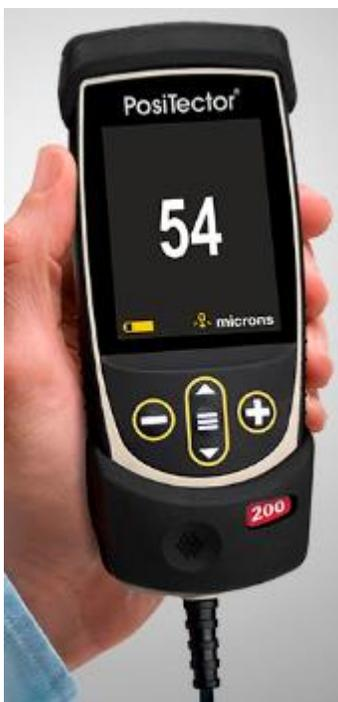
El PosiTector DF-200-B1 es un equipo de ultrasonido diseñado para medir espesor de recubrimiento sobre superficies no metálicas como la madera y el plástico.
