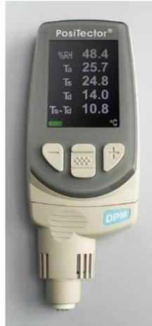
Mide y registra las condiciones climáticas incluyendo: Humedad relativa, temperatura del aire, temperatura de la superficie, temperatura del punto de rocío, velocidad del viento y diferencia entre las temperaturas de superficie y punto de rocío. Ideal para la preparación de superficies según las normas ISO 8502-4, BS 7079-B4, ASTM D3276, IMO PSPC, SSPC-PA7 y US Navy NSI 009-32.
