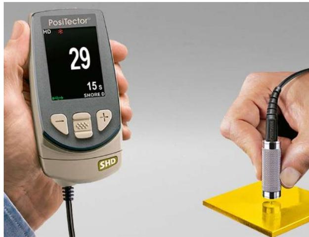
El durómetro de dureza Shore Shore de PosiTector es un instrumento electrónico de mano que mide la dureza de indentación de materiales no metálicos. Dos modelos de durómetro están disponibles para diferentes rangos de dureza - Shore A y Shore D en la versión estándar o avanzado.
