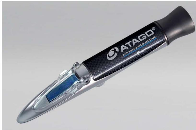
El MASTER-53a es un Modelo de amplio rango de medición (0.0 a 53.0% Brix) que tiene la capacidad de medir no solamente varios tipos de jugos, café y otras bebidas sino también comida procesada como ketchup, mermelada baja en calorías, etc.
