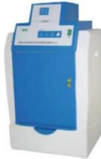
El sistema de documentación de geles sirve para observar, tomar fotos y analizar bandas de los geles posteriores a la electroforesis.
