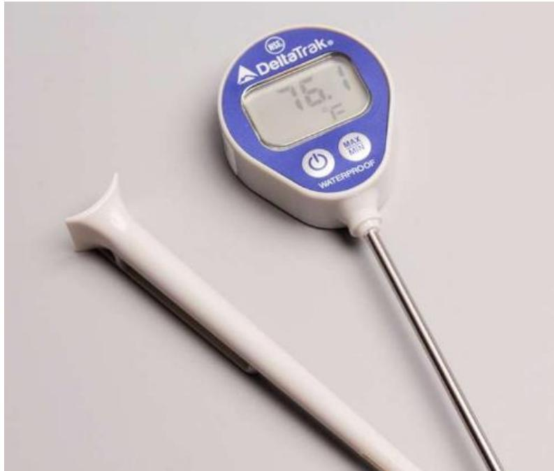
El Termómetro Bimetálico TK-11050 tipo paleta. Es un termómetro impermeable que registra la temperatura más alta, hasta en un lavavajillas de alta temperatura para verificar que se ha alcanzado la temperatura adecuada de desinfección.
