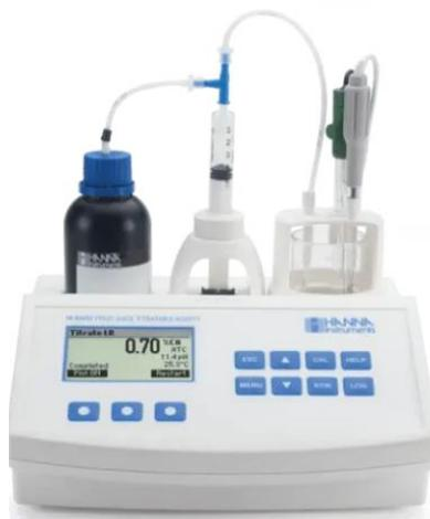
El HI84532 es un equipo fácil de usar, rápido y de precio óptimo para los análisis de la acidez de jugo de fruta. Basado en un método de titulación ácido-base, este minititulador utiliza un método programado de análisis que incluye un algoritmo que determina el punto final de la titulación mediante un electrodo de pH con cuerpo de vidrio.
