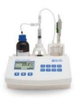
El Hl84531 es un equipo fácil de usar, rápido y de precio óptimo para los análisis de la alcalinidad titulable en agua. Basado en un método de titulación ácido-base, este minititulador utiliza un método programado de análisis que incluye un algoritmo que determina el punto final de la titulación mediante un electrodo de vidrio de pH.
