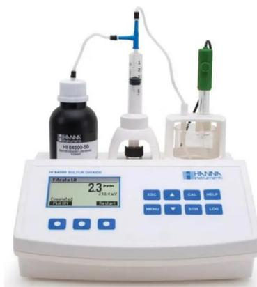
El HI84500 es un equipo fácil de usar, rápido y de precio óptimo para los análisis del dióxido de azufre libre o total ( $\text{SO}_2$ ) en el vino. Basado en el método Ripper, este minititulador utiliza un método optimizado de análisis con un potente algoritmo que determina el punto final de la reacción de titulación usando un electrodo de ORP diseñado para este fin.
