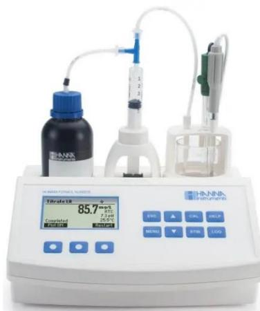
El HI84533 es un equipo fácil de usar, rápido y de precio óptimo para los análisis de formol en los vinos o jugos de frutas. Basado en un método de titulación ácido-base, este mini titulador utiliza un método de análisis optimizado con un potente algoritmo que determina el punto final de la reacción de titulación mediante el uso de un electrodo de pH con cuerpo de vidrio.
