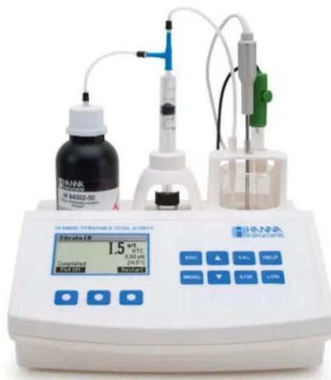
El HI84502 es un equipo fácil de usar, rápido y de precio óptimo para los análisis de acidez total en el vino. Basado en un método de titulación ácido-base, este mini titulador utiliza un método de análisis optimizado con un potente algoritmo que determina el final de la reacción de titulación mediante el uso de un electrodo especializado de pH para vino.
