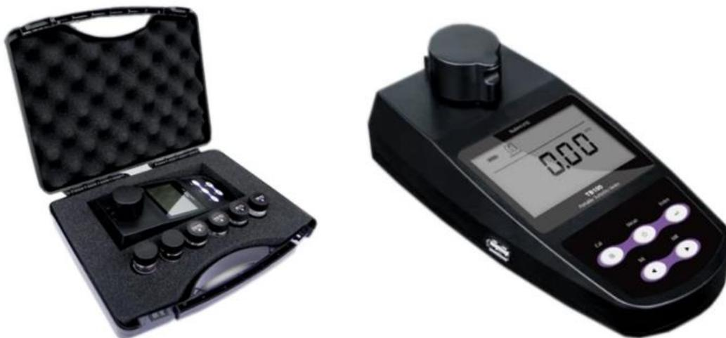
Medidor portátil de turbidez de gran utilidad, ideal para aplicaciones al aire libre, ya que funciona con baterías AA. Cuenta con un excelente sistema óptico brindando lecturas confiables y precisas. Ampliamente utilizado en el monitoreo de agua potable, albercas, acuarios, ambiental y control de procesos industriales. Incluye celdas de muestra, estándares de calibración y estuche.
