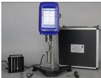
El Viscosímetro rotatorio digital modelo BL-BGD152/1 es la alternativa actual en comparación con el uso del viscosímetro rotativo de carátula. Realiza las mediciones por medio de un circuito tipo microcomputador que mide la viscosidad de una muestra líquida y despliega en pantalla el resultado de la medición y todos los parámetros de la prueba.
