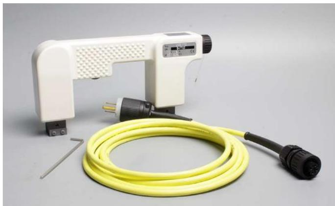
El imán del yugo de la mano de CA UM 9 / HANSA-42 funciona con un voltaje de entrada de 42 V.
