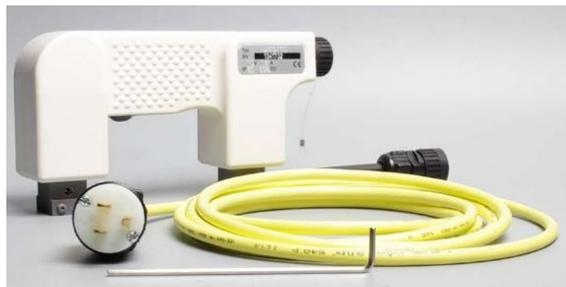
Una alta intensidad de campo del yugo de magnetización manual UM 10 / HANSA-230 se logra mediante la disposición de los devanados directamente en los polos.
