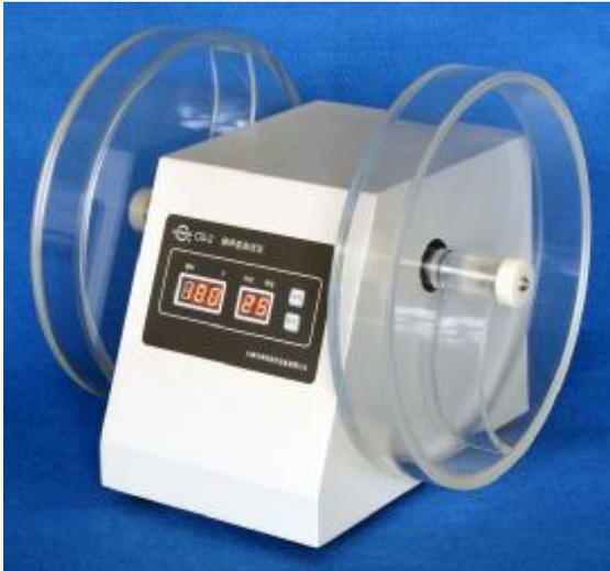
**Friabilizador para detectar la Friabilidad /abrasión de las tabletas.** Con 2 tambores de acrílico que giran sincronizadamente durante el tiempo programado y se detiene de manera automática. La velocidad y revoluciones pueden establecerse en cualquier momento, el programa y los datos en tiempo real se muestran en una pantalla de LEDS, tiene autoalarma y autodiagnostico.
